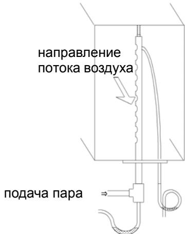
Предпочтительным является горизонтальный монтаж парораспределителей, но возможен и монтаж в климатический канал снизу.
