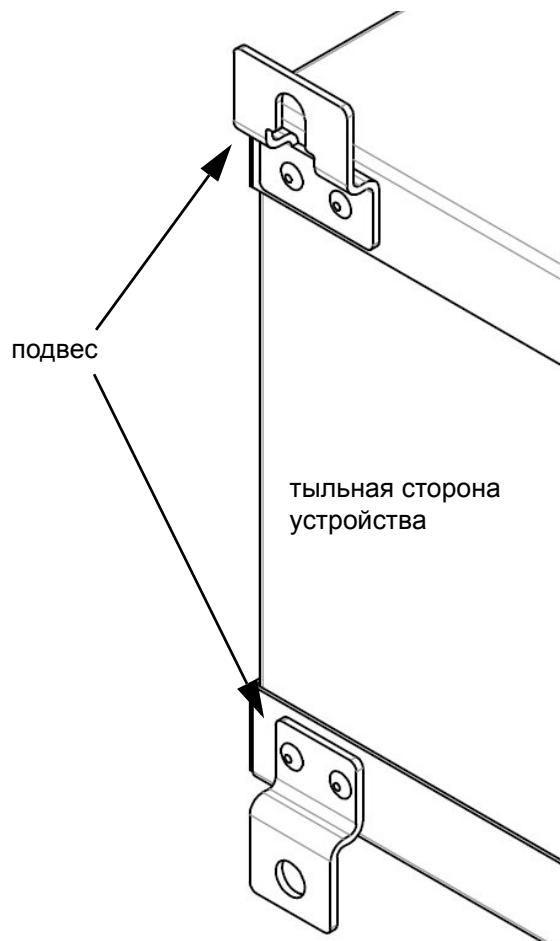
Монтаж устройства должен выполняться на прочной стене.
