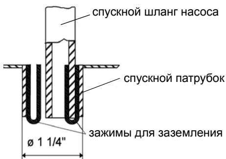
С внутренней стороны спускного патрубка корпуса расположены две скобы для заземления. Во время очистки от шлама или в случае ошибки при переливе они непосредственно контактируют с водой и отводят остаточные токи на корпус.
